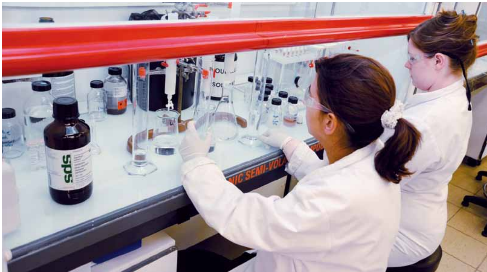
Opérations de contrôles qualité effectuées sur des poudres alimentaires. La manipulation de produits dangereux oblige à respecter des règles de sécurité : port de gants, de lunettes... Les opérations sont effectuées sous un puissant extracteur d'air.
