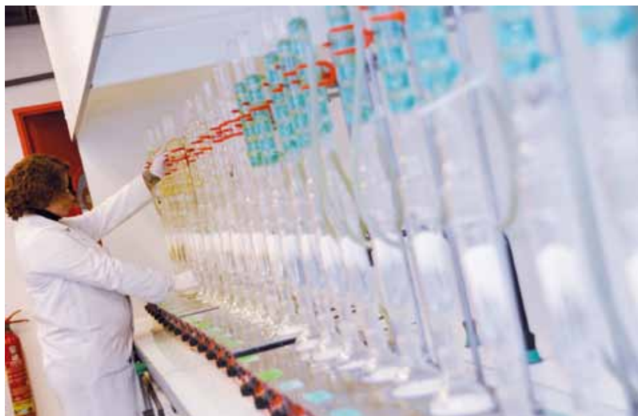
Ces extracteurs de Soxhlet permettent de mesurer les quantités de matières grasses contenues dans une poudre.
