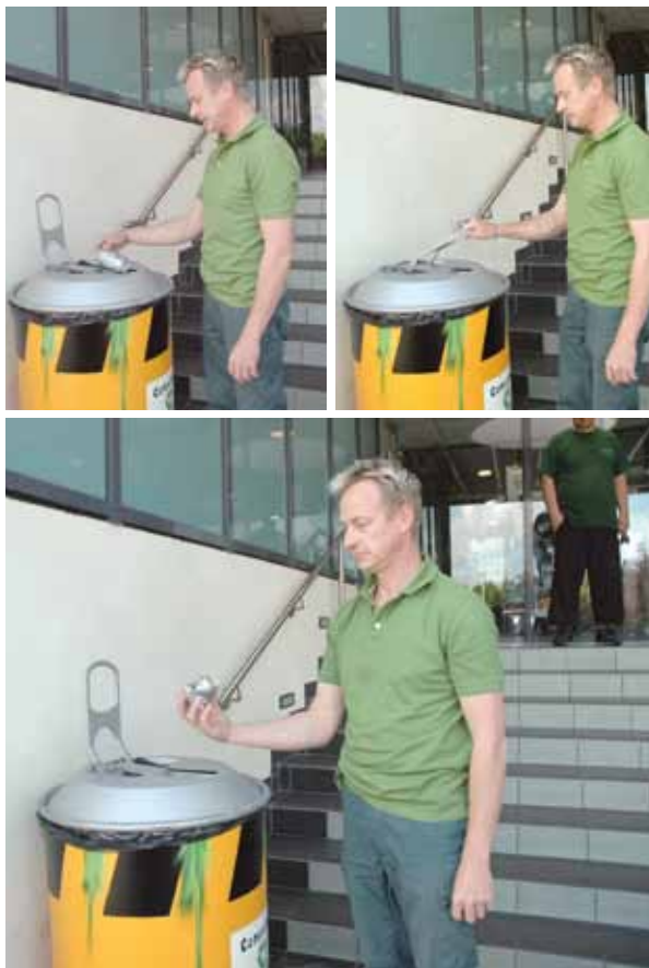
Le crashcan ou compacteur de canettes métalliques en trois étapes : mettre la canette, abaisser le levier, la canette est compactée et tombe au fond du compacteur.
