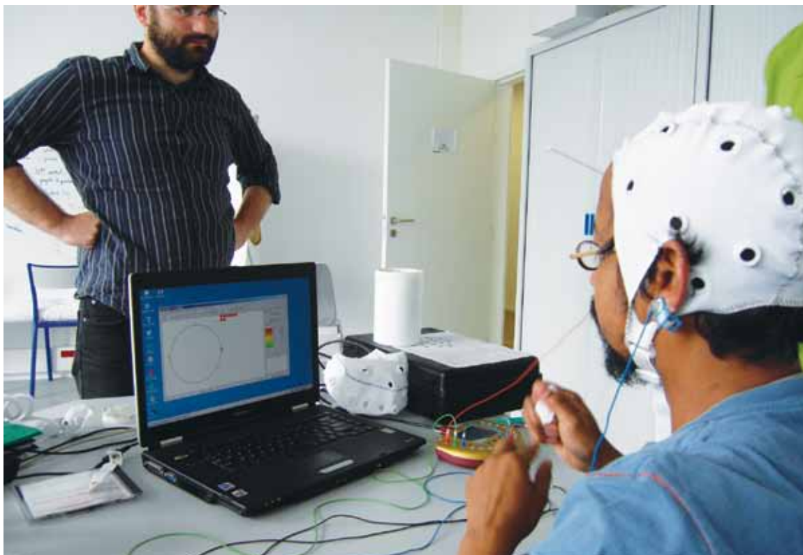
Expérience sur les interfaces machine-cerveau menée par le Litis. Les électrodes captent les données émises par le cerveau, puis les traitent par des techniques d'apprentissage statistiques afin de reconnaître des phénomènes physiologiques ou psychiques, et de construire des modèles prédictifs du comportement.
