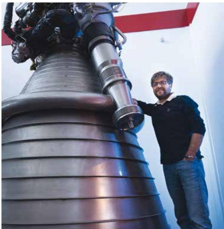
◀ Le moteur Vulcain utilisé par la fusée Ariane est présent dans les locaux de l'Insa de Rouen. Pour Guillaume Ribert, c'est une chance donnée aux étudiants d'appréhender concrètement les enjeux physiques et mécaniques de la propulsion aérospatiale.
